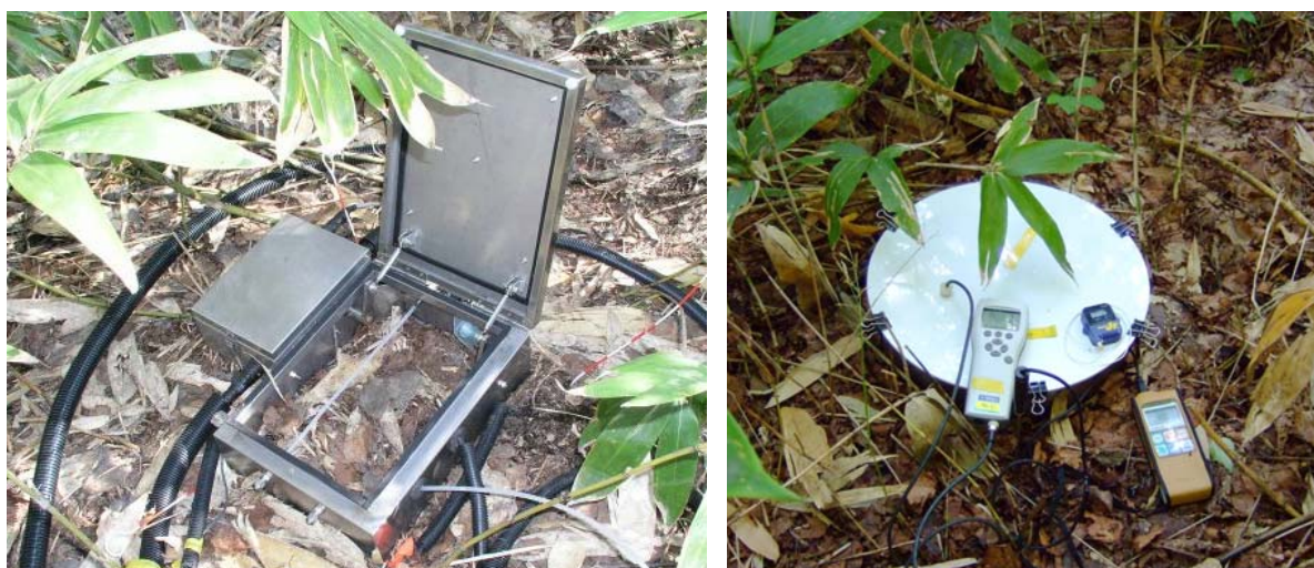
写真-2 土壌呼吸測定システム（左：自動観測、右：多点手動観測）
